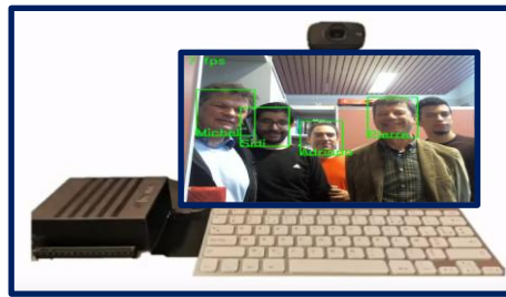
FIGURE 4 : SYSTÈME IA UTILISANT LA RESSOURCE EDGE "JETSON XAVIER"
