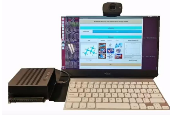
FIGURE 6 : SYSTÈME IA UTILISANT LA RESSOURCE EDGE "JETSON XAVIER"
